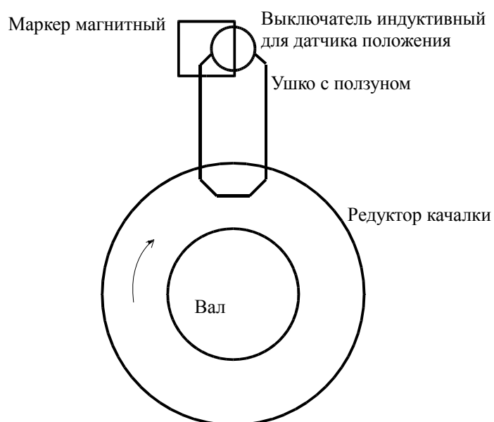
Рис.3. Правильная установка маркера магнитного относительно выключателя индуктивного в нижней мертвой точке плунжера насоса
